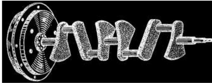
Las bielas se unen al cigüeñal en cada codo, por la cabeza, formando un sistema de biela-manivela. El cigüeñal se apoya sobre el cárter, o mejor dicho, en los cojinetes situados en él. El volante de inercia cumple la función de homogeneizar el giro del cigüeñal. El movimiento del cigüeñal no se transmite directamente al eje de la hélice, si no que va acoplado a un reductor, con un sistema de engranajes que adecua la velocidad de salida a la requerida en la hélice.
