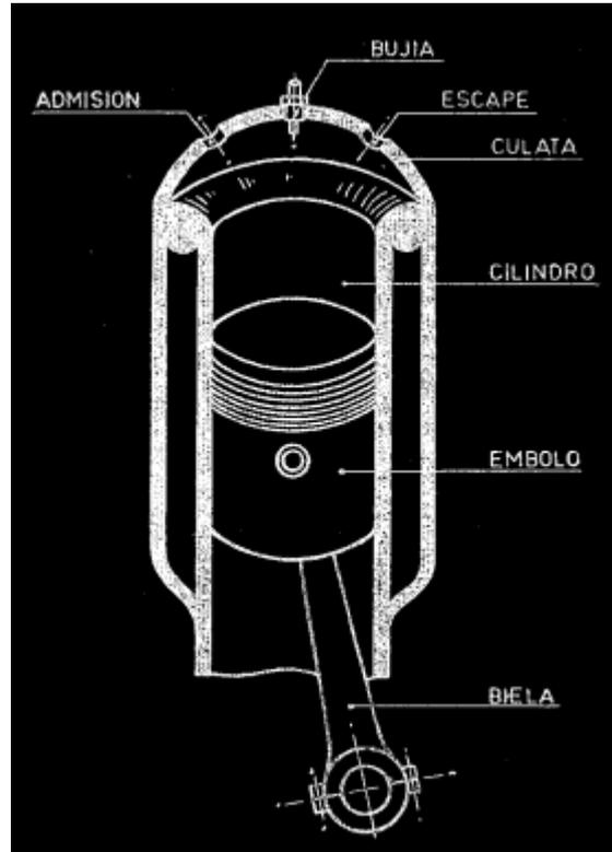
Es el recipiente en el que se realiza la explosión de la mezcla. Al tener una pared móvil (pistón), el aumento de presión que produce la explosión en el interior hace que esta pared móvil adquiera un movimiento rectilíneo. Es decir, al quemar la mezcla, los gases aumentan violentamente de volumen, y al aumentar éste hace que el pistón se desplace a lo largo del cilindro.
