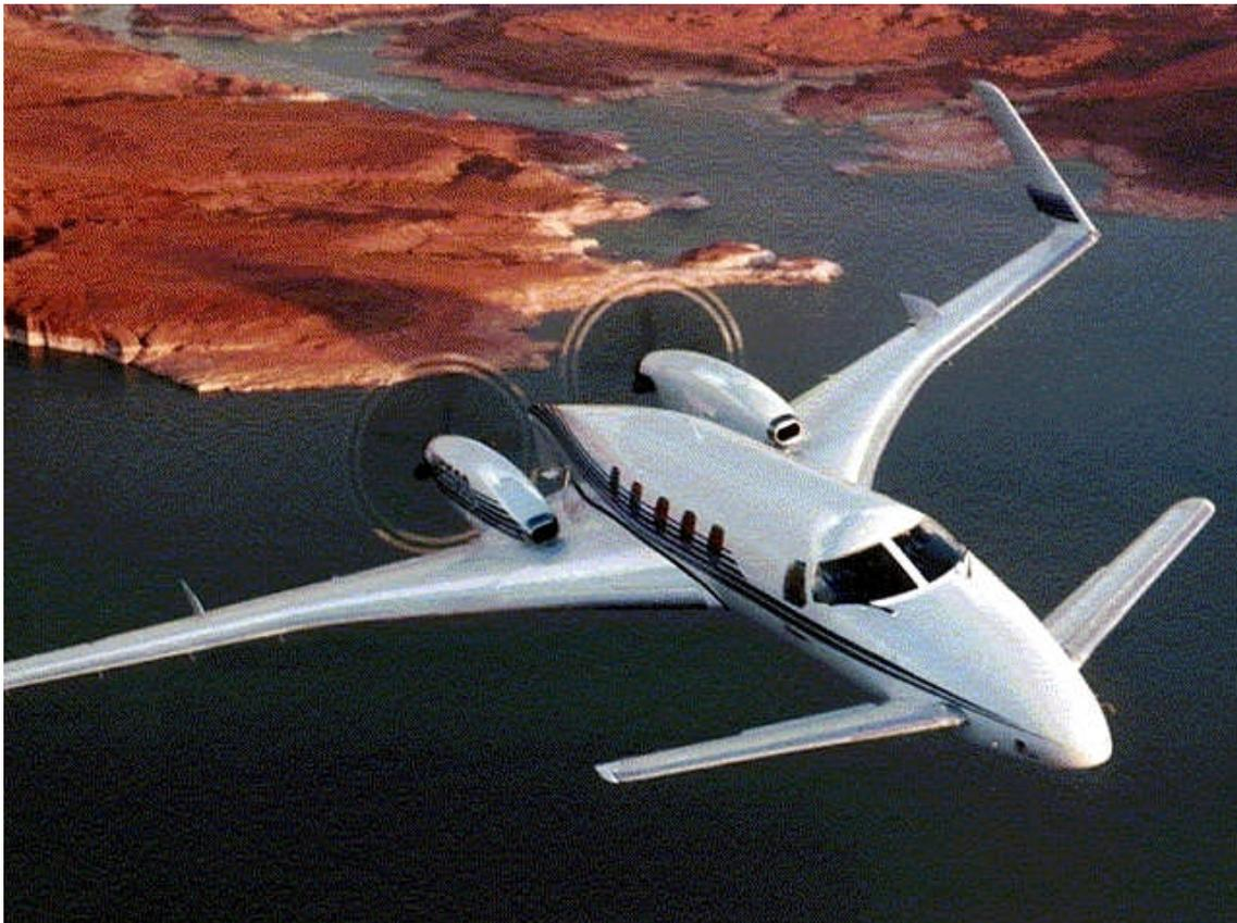
Raytheon Beechcraft 2000 Starship: Configuración Canard (“la cola delante”) y hélices impulsoras (las hélices empujan al avión)
