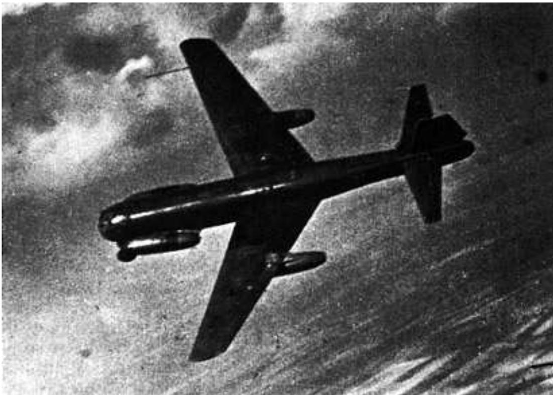
Junkers Ju 287: Avión con ala en flecha negativa (si, la cabina está en la parte izquierda de la foto y la cola en la derecha)
