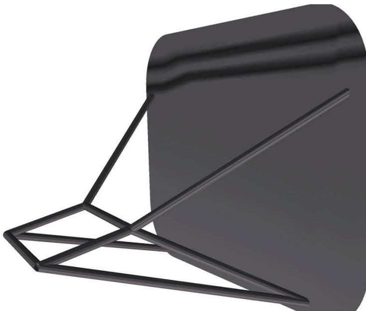
*Bancada del motor más cuaderna parallamas o cortafuegos (se interpone entre el motor y el cockpit). Modelado por Marcelino Montero en Catia V5*
